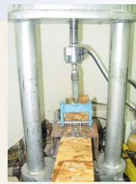
▲IC野地板用ビス引抜き強度試験
