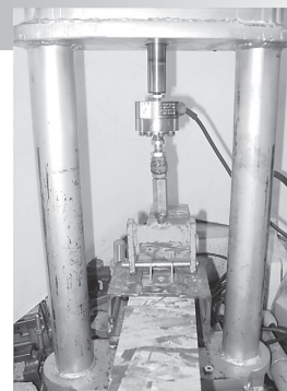
▲IC野地板用ビス引抜強度試験
