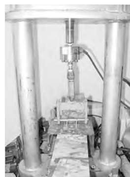
▲IC野地板用ビス引抜き強度試験
