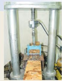
▲IC野地板用ビス引抜き強度試験
